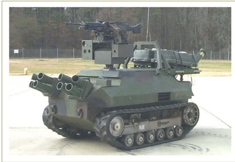
Figura 1. Gladiator Tactical Unmanned Ground Vehicle - vehículo teleoperado del cuerpo de marina de Estados Unidos.
