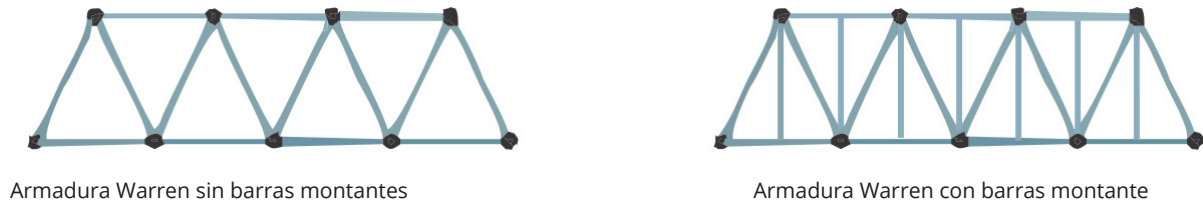
Armadura Warren sin barras montantes
