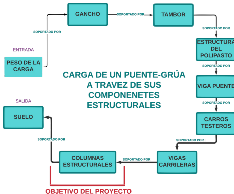
Figura 2. Diagrama de bloques de la transmisión de las cargas de un elemento estructural a otro
