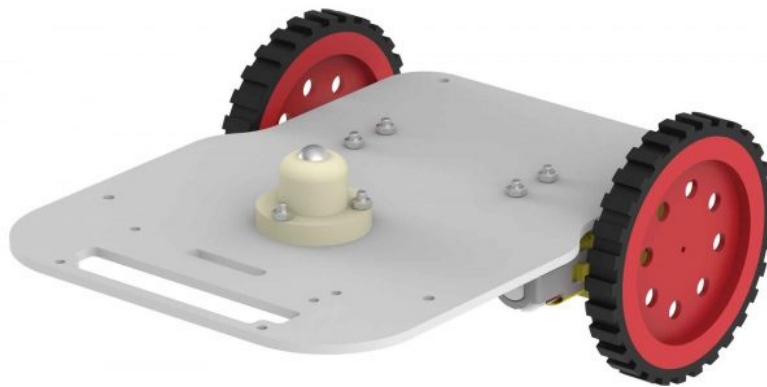
Figura 23. Plataforma móvil diferencial con rueda castor
