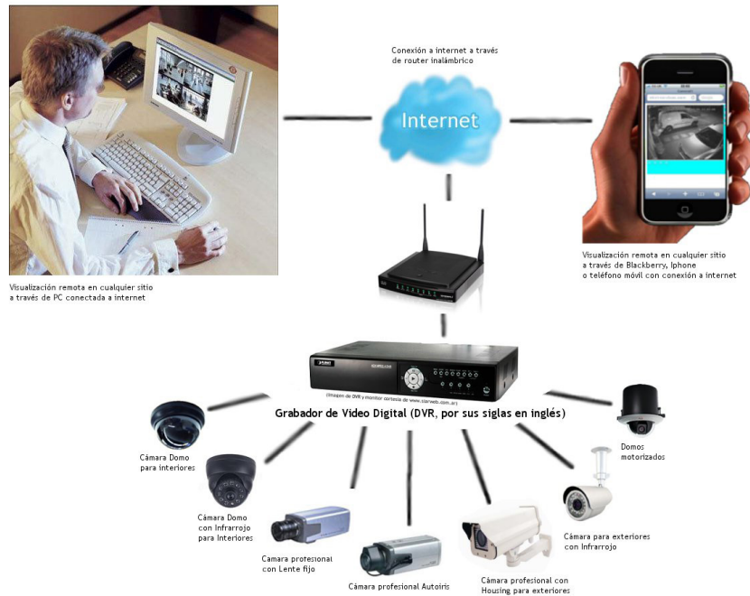
Figura 1. Esquema de componentes de un CCTV
