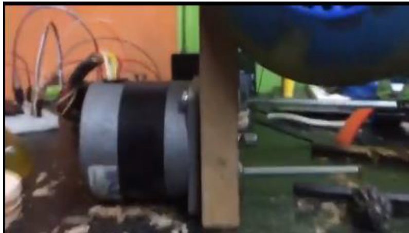
Figura 12. Motor paso a paso en funcionamiento
